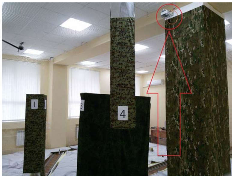
Рис. 2 – Расположение приемников на испытательном полигоне.
