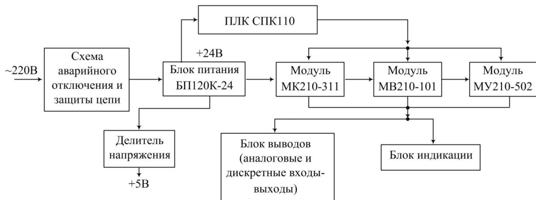
Рис. 1. – Функциональная схема лабораторного стенда
