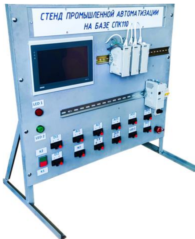
Рис. 3. – Внешний вид лабораторного стенда на базе СПК110
