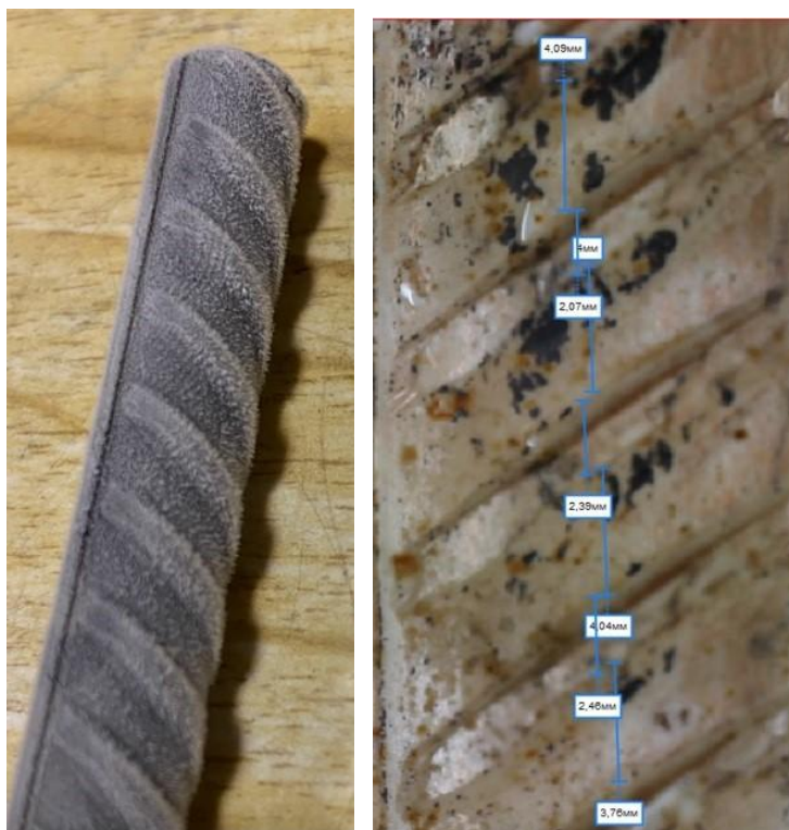
Рис. 3. – Измерение геометрических параметров арматуры с кольцевыми выступами методом снятия реплик
