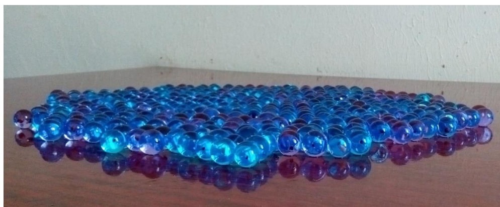
Рис. 6. – Откос в покое ампул из гидрогеля, заполненных рабочим раствором
