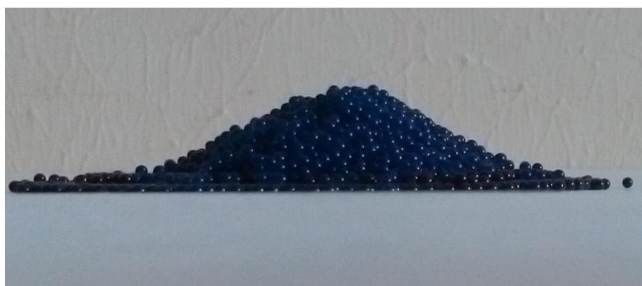
Рис. 5. – Откос в покое ампул из гидрогеля без рабочего раствора
