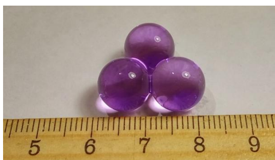
Рис. 3. – Общий вид ампул, заполненных рабочей жидкостью
