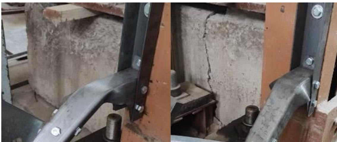
Рис. 8. – Разрушение консоли корзины
