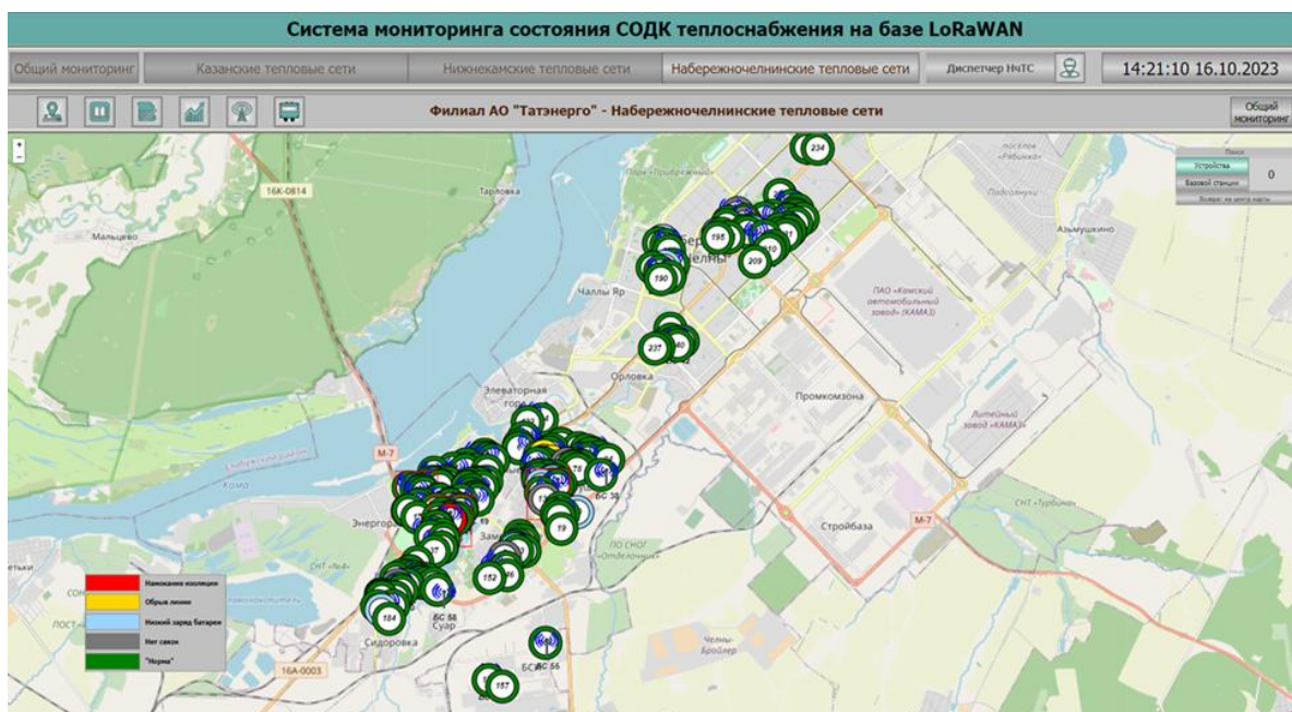
Рис. 3. – Web-интерфейс технологии LoRaWAN для сбора показаний СДОК
