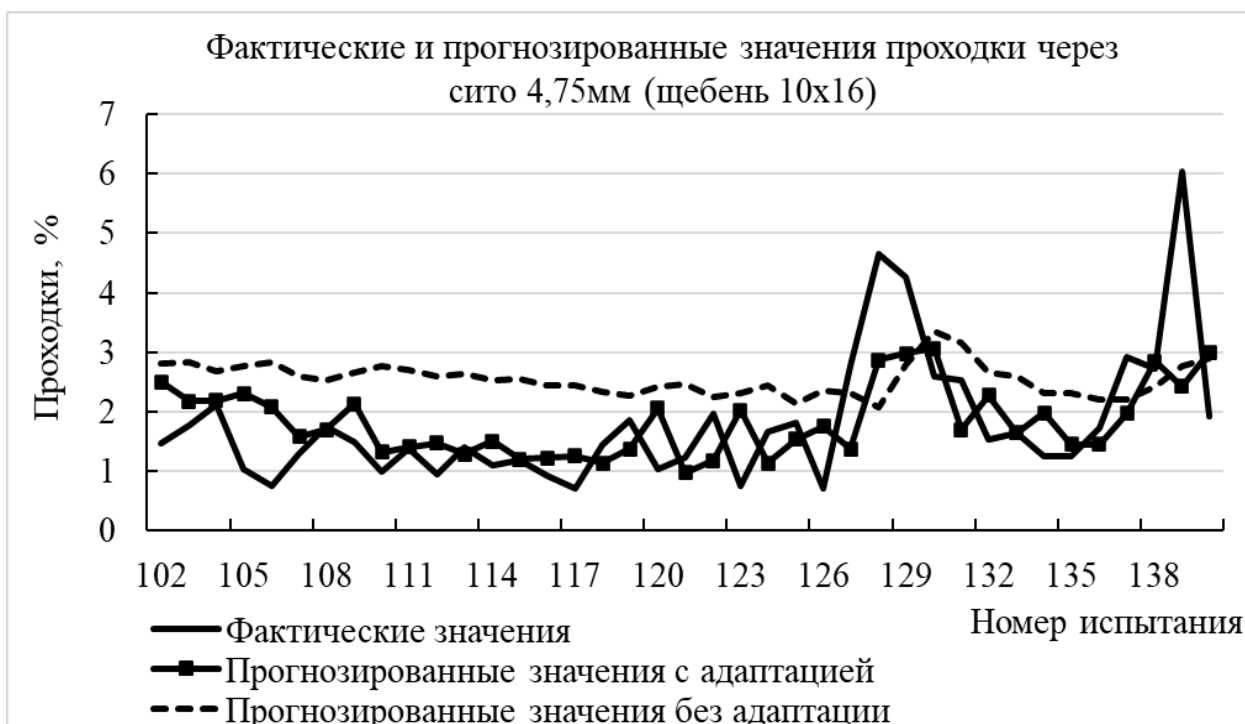
Рис. 6. – Фактические и прогнозные значения проходки через сито 4,75мм без адаптации и с адаптацией
