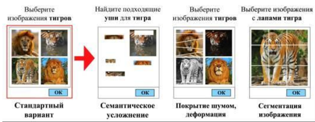
Рис. 2. – Возможные методы защиты теста CAPTCHA, основанного на распознавании и классификации изображений
