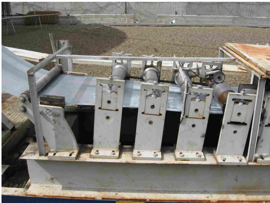
Рис. 3. Профилегбочный стан формовки гнутолистого профиля
