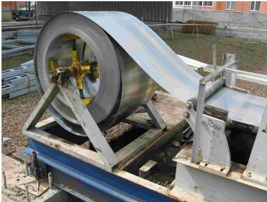
Рис. 2. Рулон тонколистовой стали профилегбочного стана
